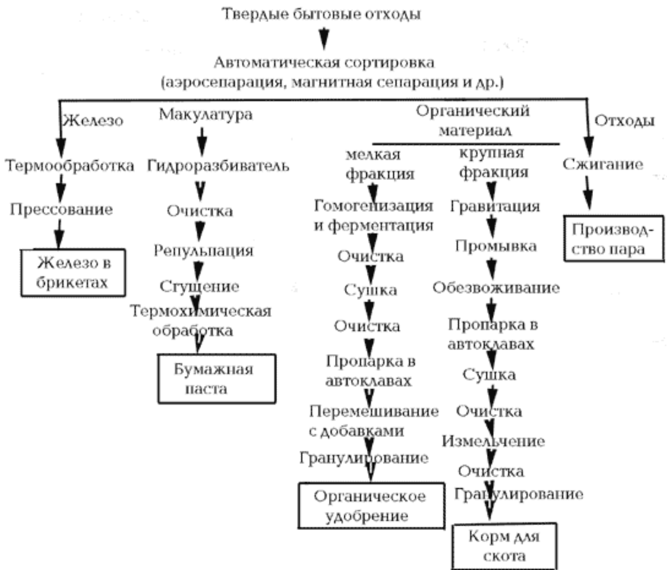
Рис. 7.1. Принципиальная схема промышленной переработки отходов по технологии компании «Сорайн Чеккини» (Италия)
