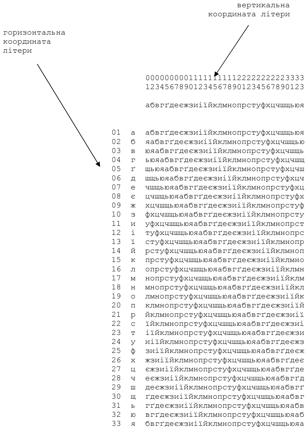
Рис. 32. Шифрування за допомогою таблиці способом зсовування абетки (абетку в кожному рядку зсунуто на одну позицію вправо стосовно попереднього; останні літери кожного рядка дописано на його початок)
