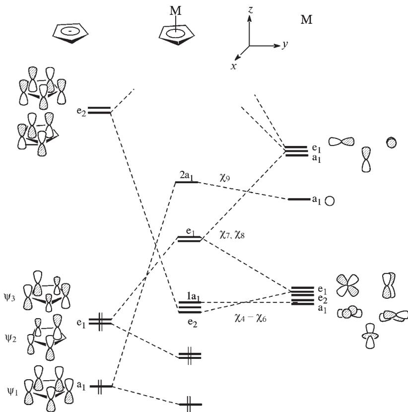
Рис. 27.10. Диаграмма орбитальных взаимодействий для фрагмента  $MCr$ , показывающая заселенность орбиталей для случая  $d^0$
