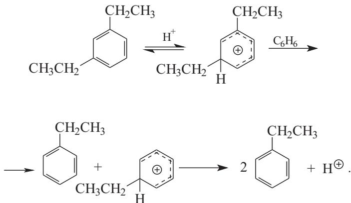
Общий выход этилбензола составляет 98%. Главная проблема этой технологии производства этилбензола заключается в коррозии аппаратуры, в которой выполняется алкилирование по Фриделю–
