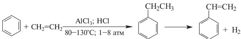
На протяжении многих лет этилирование бензола этиленом осуществлялось в жидкой фазе в присутствии безводного хлорида алюминия, промотированного HCl или  $\text{CH}_3\text{CH}_2\text{Cl}$ . Для того, чтобы уменьшить долю продуктов полиалкилирования, бензол берется в избытке, типичное соотношение бензола и этилена составляет 2:1. Тем не менее, наряду с этилбензолом получается немного диэтилбензола, который превращают в этилбензол трансалкилированием бензола:
