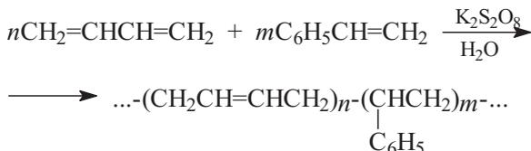
Полимеризацию обычно проводят в водной эмульсии при 50 °С, используя в качестве инициатора персульфат калия, или при 5 °С, иницируя полимеризацию лаурилгидропероксидом и сульфатом железа (II). Твердый полимер получается при коагуляции эмульсии с помощью кислоты или сульфата алюминия. В обоих вариантах полимеризация протекает по радикальному механизму. Производство бутадиен-стирольного синтетического каучука в США составляет 950 000 т.
