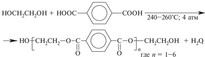
Затем в реакционную смесь вводят  $\text{Sb}_2\text{O}_3$  — катализатор переэтерификации и продолжают реакцию при тех же условиях. В результате переэтерификации получаются полиэтилентерефталат и этиленгликоль, который удаляют отгонкой в вакууме при 280–290 °С.
