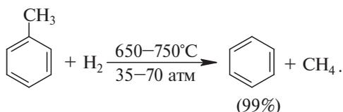
Известны два варианта этого процесса: (1) на смешанных оксидах алюминия, молибдена и кобальта при 550–650 °С и при давлении 35–70 атм; (2) некаталитический при 650–750 °С; выход бензола в обоих случаях достигает 99%. Диспропорционирование толуола до бензола и смеси трех изомерных ксилолов осуществляется на кислотных катализаторах, например на цеолитах при 450–500 °С.
