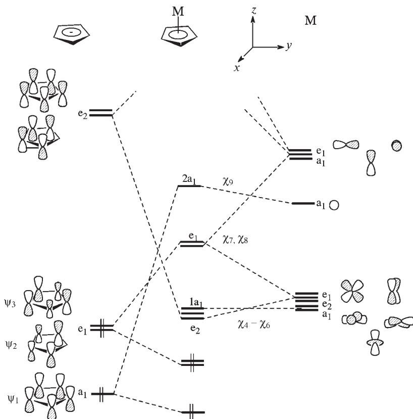
Рис. 27.10. Диаграмма орбитальных взаимодействий для фрагмента  $M\text{-Cp}$ , показывающая заселенность орбиталей для случая  $d^0$
