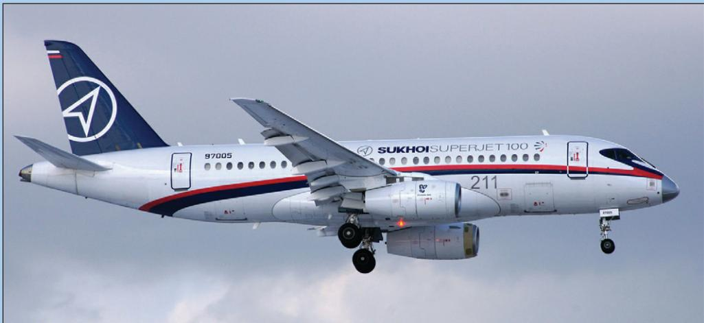
Пассажирский самолет Сухой Суперджет-100 (Sukhoi Superjet-100, ранее название RRJ - Russian Regional Jet) примечателен тем, что является первым самолетом, разработанным в России после распада СССР с использованием цифровых технологий. Самолет предназначен для эксплуатации на малозагруженных авиалиниях протяженностью до 3000 км (базовая комплектация) и до 4500 км (LR - комплектация с увеличенной дальностью полета). Количество пассажирских мест – 95–98 (эконом класс)
