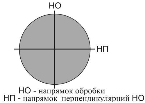
Рис. 4.5 Рівномірний розподіл полюсів по площині проєкцій при відсутності текстури
