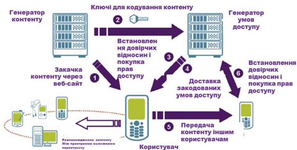
Рис. 2.6. Принцип роботи мобільного DRM
