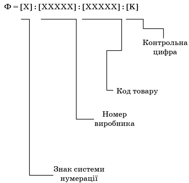
Рис. 2.6. Структура штрихового коду EAN-12
