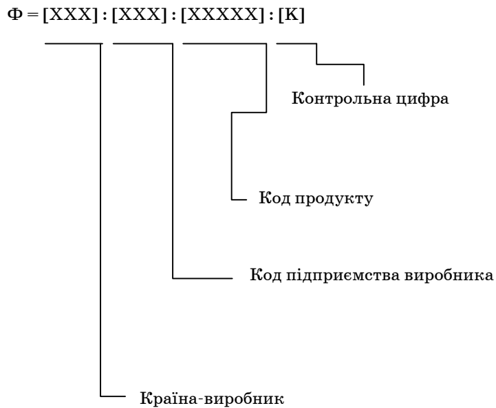
Рис. 2.8. Структура штрихового коду EAN-13
