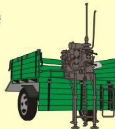
Пристрій для добування води УДВ-15
