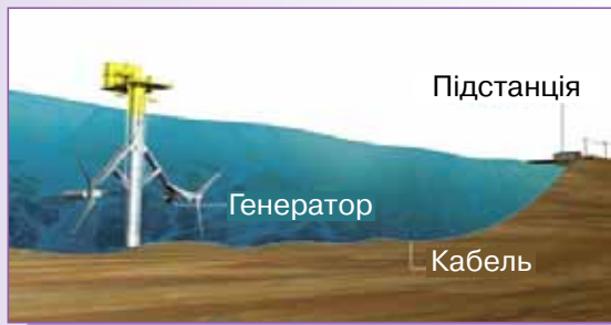
Мал. 3.13. Схема дії: а — теплового насоса; б — припливної електростанції
