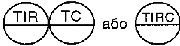
Рисунок 2.2 – Умовні позначення на схемах автоматичного містка
