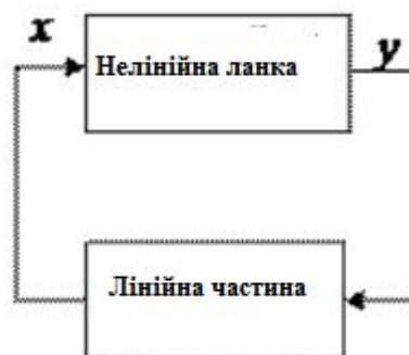
Рисунок 1.26 – Спрощена структурна схема замкнутої нелінійної системи
