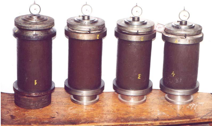
Рис. 8.9. Релаксометры в процессе испытаний УЭ амортизаторов сжатия
