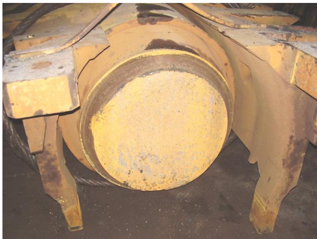
Рис. 2. Разрушенный рабочий валок толстолистового стана 3000
