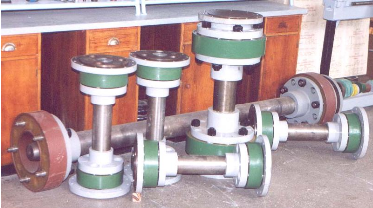
Рис. 1.5. Упругие валы для РБЦ МК «Азовсталь»
