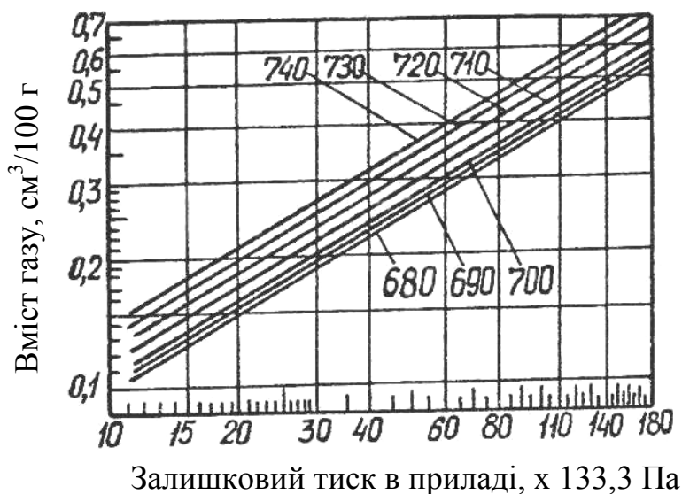
Рисунок 4.2. – Номограма для визначення вмісту водню в алюмінії і сплавах АК6, Д1, Д16 по методу першого пузирка (цифри у прямих – градуси по Цельсію)
