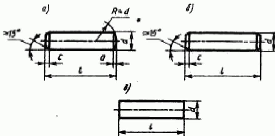
а - исполнение 1 (класс точности А); б - исполнение 2
