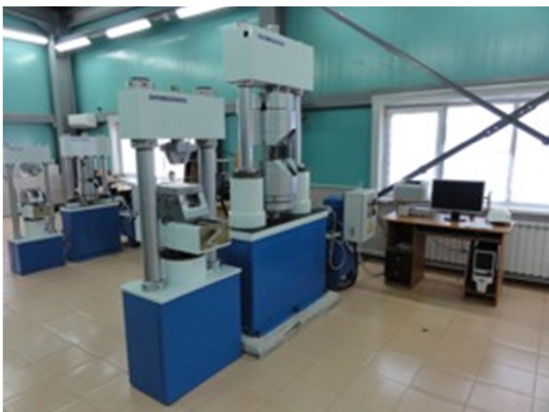
Рис. 3.8 - Зразки металу піддаються випробуванню розривними гідравлічними машинами
