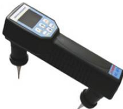
Рис. 3.25 - Ультразвуковий прилад з візуалізацією (дефектоскоп) ПУЛЬСАР- 2.2
