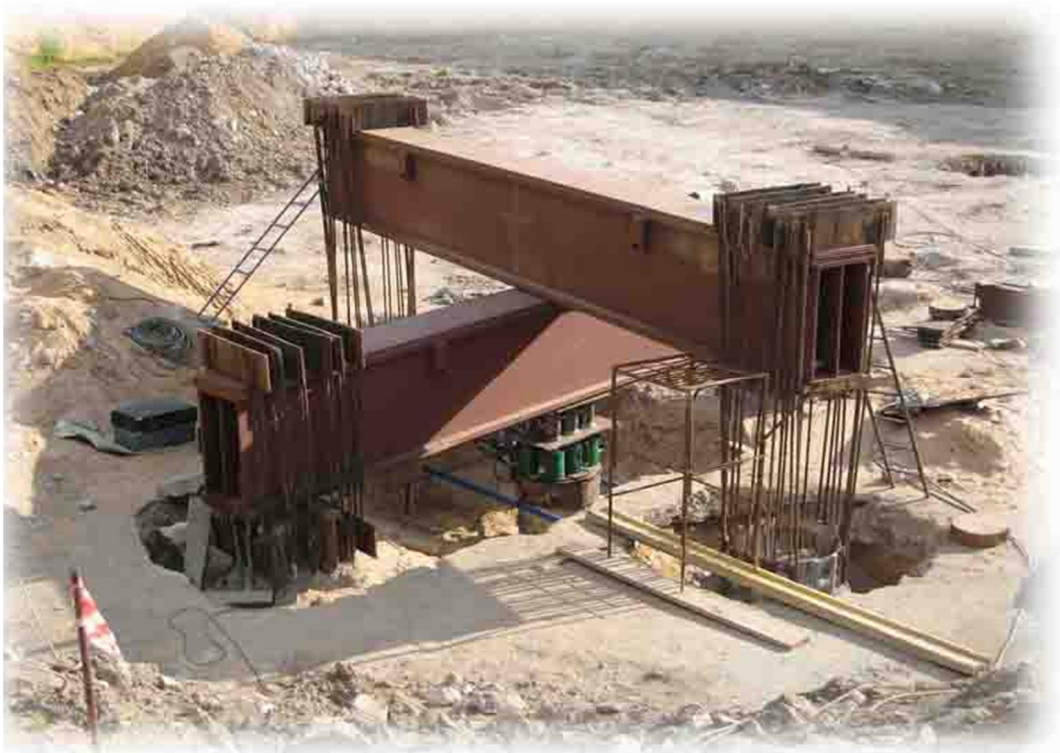
Рис. 4.3 - Випробування талих ґрунтів динамічним (ударним або вібраційним) навантаженням
