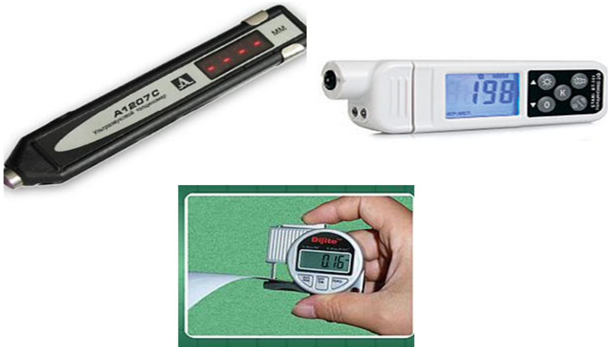
Рис. 3.19 – Ультразвуковий портативний товщиномір металу
