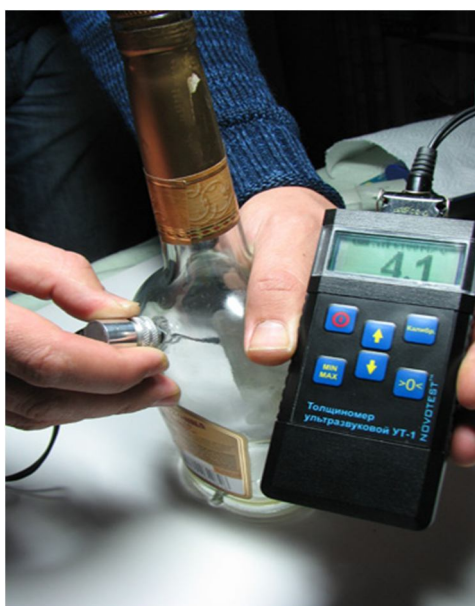
Рис. 3.18 - Ультразвуковий товщиномір NOVOTEST УТ- 1
