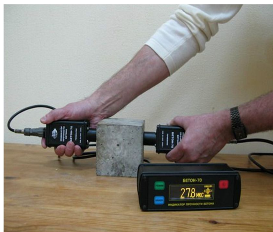
Рис. 3.26 - Дефектоскоп ультразвуковою для визначення міцності бетону
