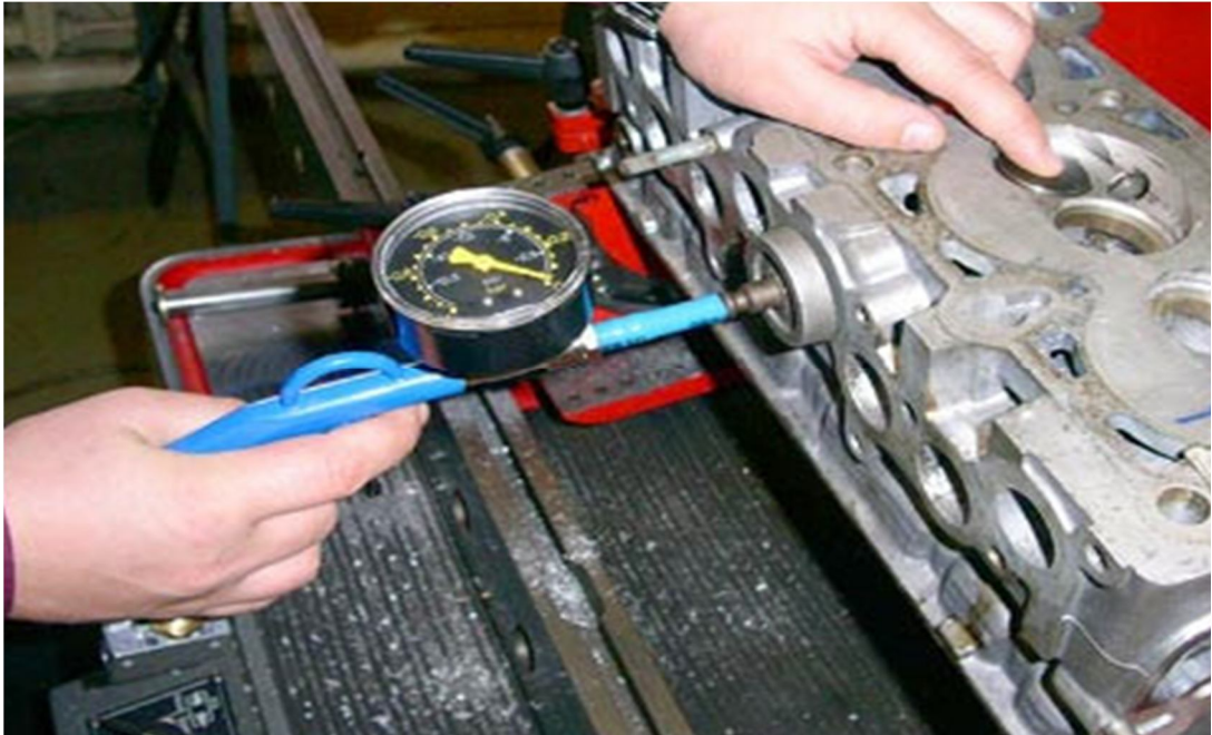
Рис. 3.12 - Застосування вакууму при контролі герметичності з'єднань
