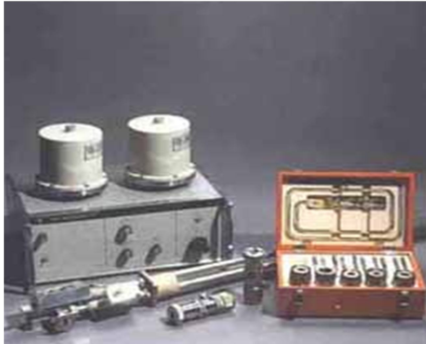
Рис. 1.6 - Еталон одиниці сили електричного струму — ампер
