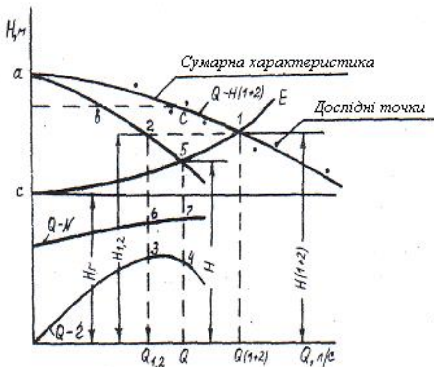
Рисунок 6.7 - Характеристики двох відцентрових насосів з однаковими характеристиками при їхній паралельній роботі
