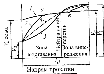
Рис. 5.6 Співвідношення швидкостей валків і штаб в осередку деформації за наявності зони прилипання:
