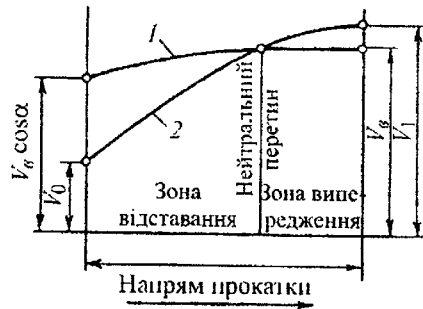
Рис. 5.4 Співвідношення швидкостей валків і штаб в осередку деформації:
