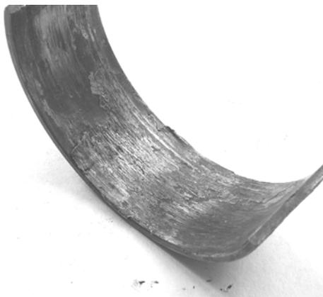
Рис. 3.3. Вид поверхности при износе схватыванием второго рода
