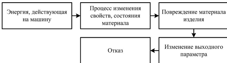
Рис. 1.6. Схема накопления причинных воздействий отказа
