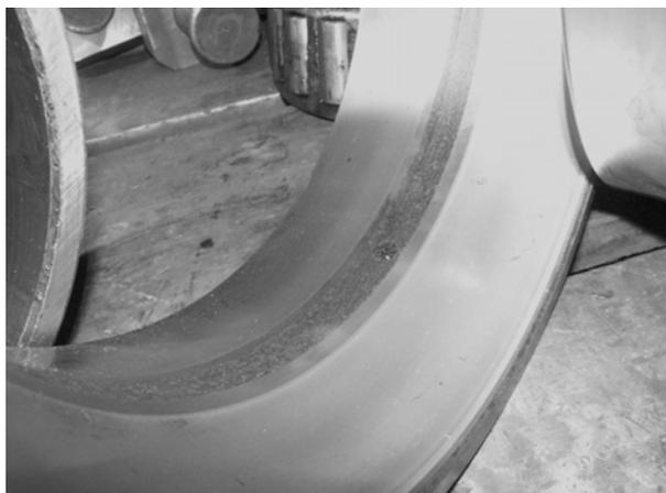
*Рис. 3.17. Окислительный износ беговых дорожек конического роликоподшипника*
