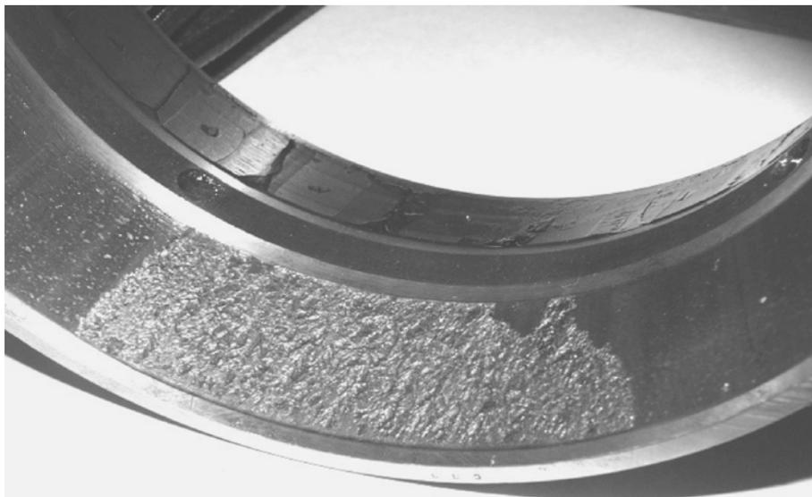
*Рис. 3.5. Вид оспвидного износа на поверхности наружного кольца подшипника*
