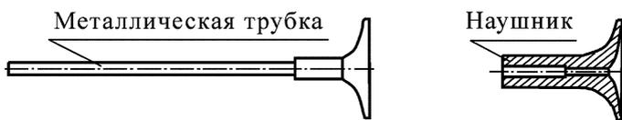
Рис. 2.3. Технический стетоскоп
