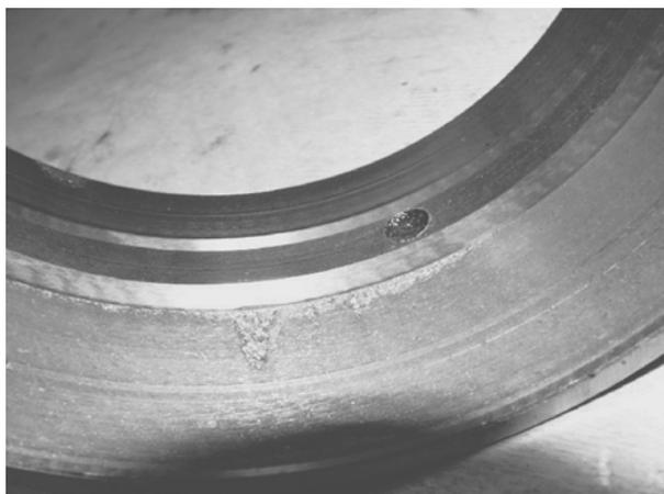
*Рис. 3.16. Абразивный износ рабочей поверхности кольца подшипника*
