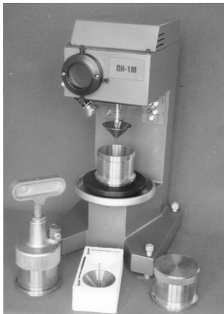
*Рис. 5.4. Пенетрометр
