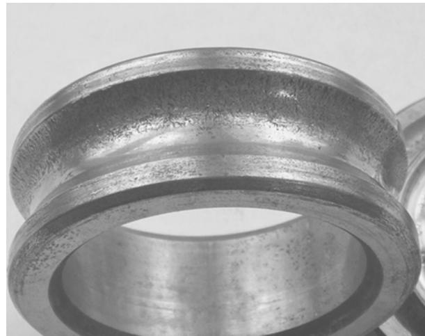
Рис. 3.13. Смещение следов изнашивания
