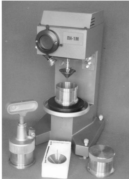
*Рис. 5.4. Пенетрометр
