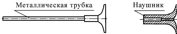
Рис. 2.3. Технический стетоскоп
