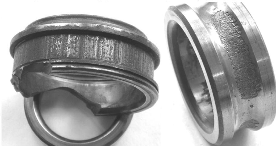
*Рис. 3.11. Местное изнашивание внутреннего кольца при колебательном движении подшипника*
