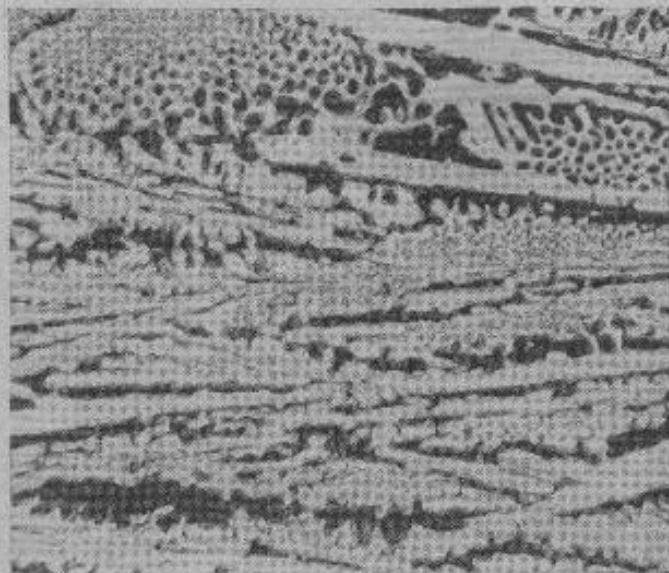
Фиг. 106. Микроструктура заэвтектического чугуна (Кашенко).
