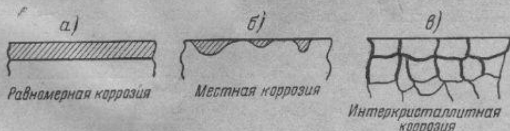
Фиг. 504. Основные виды коррозионных разрушений.
