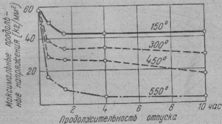
Фиг. 238. Влияние температуры и продолжительности отпуска на величину остаточных напряжений. Сталь 0,3% С, диаметр 50 мм (Бухгольц, Бюллер и Шульц).
