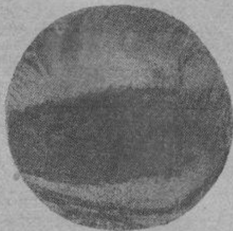
Фиг. 146. Излом болта, сломавшегося от усталости при переменном изгибе (Д. Н. Видман).
