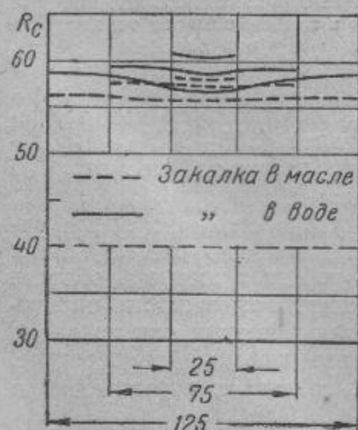
Фиг. 338. Распределение твердости по сечению закаленных брусков диаметром 25, 75 и 125 мм. Сталь типа 37ХНЗА.
