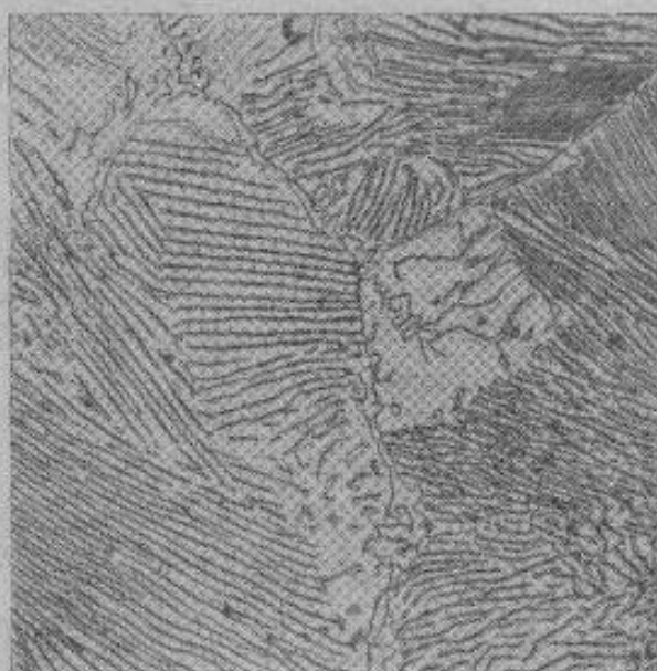
Фиг. 99. Структура перлита. \times 800 .
