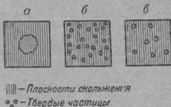
Фиг. 204. Схема, иллюстрирующая действие твердых частиц, блокирующих плоскости скольжения.
