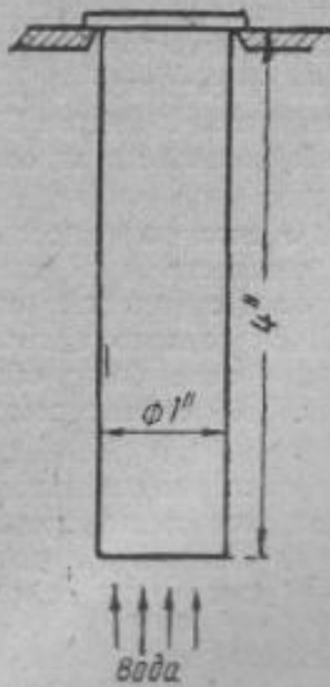
Фиг. 229. Схема закаливания образца при испытании на прокаливаемость методом торцевой закалки.
