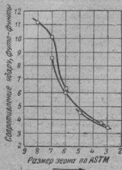
Фиг. 170. Ударная вязкость (по Изоду) в зависимости от размера зерна (Бэйн). Сталь 0,8% С. Твердость во всех случаях 50 R_c .
