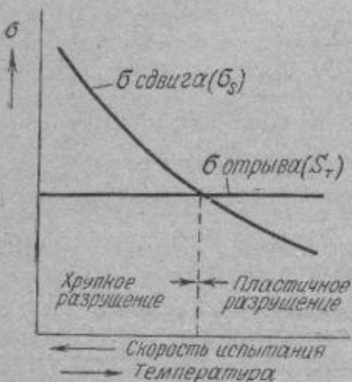
Фиг. 136. Схема А. Ф. Иоффе, объясняющая хрупкое и пластическое состояния твердых тел в зависимости от температуры (и скорости) деформации.
