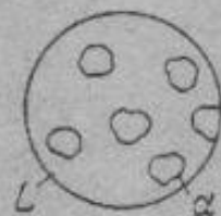
Фиг. 59. Кривая охлаждения сплава с образованием твердого раствора и схема структур.
