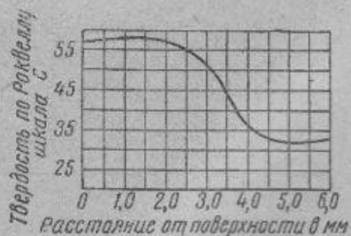
Фиг. 259. Распределение твердости по глубине цементированного слоя (сталь 18XНВА).
