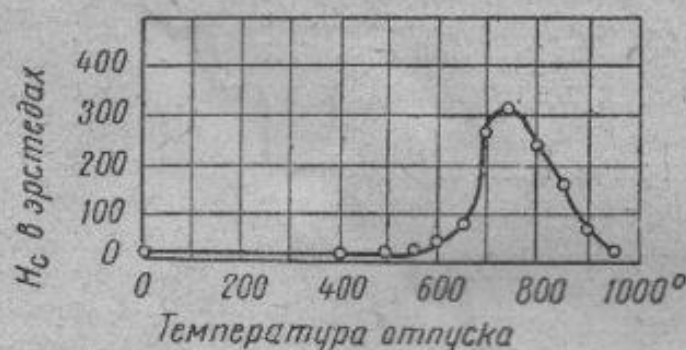
Фиг. 407. Коэрцитивная сила железоникельалюминиевого сплава (27,4% Ni; 14,7% Al), закаленного от 1270° и отпущенных в течение 1-го часа на различные температуры (Лившиц).
