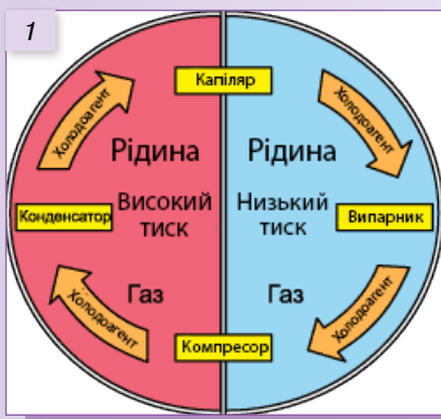
Мал. 4.11. Холодильник. 1. Принцип дії. 2. Складники двокамерного холодильника: компресор (1), нагнітальна трубка (2), конденсатор (3), фільтр-осушувач (4), капілярна трубка (5), випарник морозильної камери (6), випарник холодильної камери (7), усмоктувальна трубка (8)
