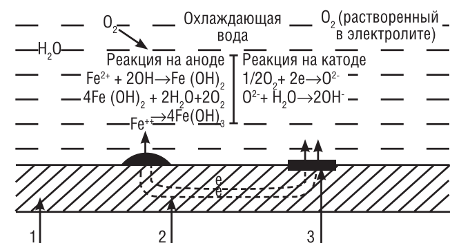
Рис. 1.24. Механизм электрохимической коррозии в системе «металл–воздух–вода»:
