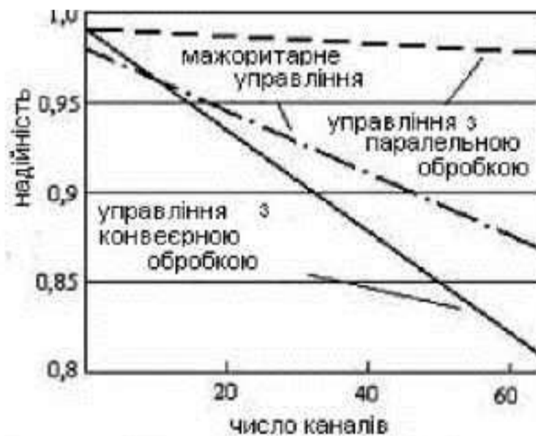
Рис. 1.5. Залежність надійності САУ з мікроЕОМ від числа каналів управління
