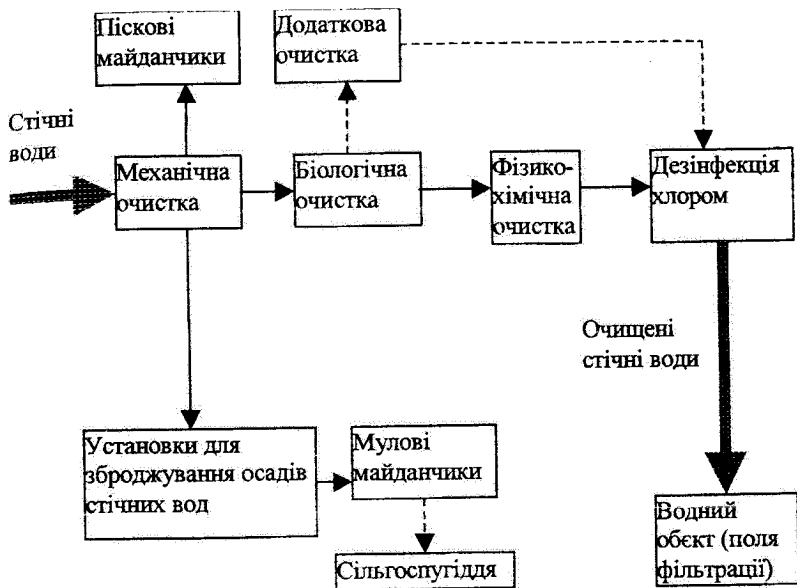
Рис. 3.15. Загальна схема видів очистки січних вод на очисних спорудах
