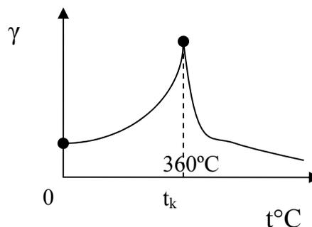
Рис.9.2 Зависимость ферромагнитной аномалии  $\gamma = C_M - C_H$  для никеля;  $T_k = 635K$ .
