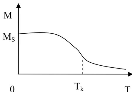
Рис. 9.1 Зависимость  $M_s(T)$  для ферромагнетика.
