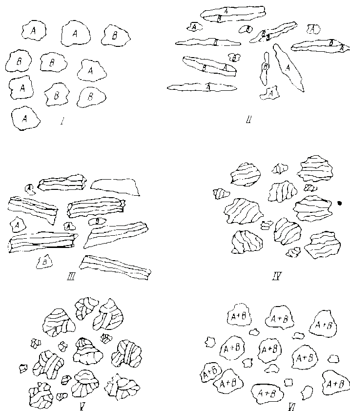
Рис. 2.7 - Стадії механічного легування.
