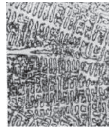
Рис.3. Микроструктура литой бронзы БрБ2 (светлый \alpha – твёрдый раствор и тёмные включения эвтектоида)
