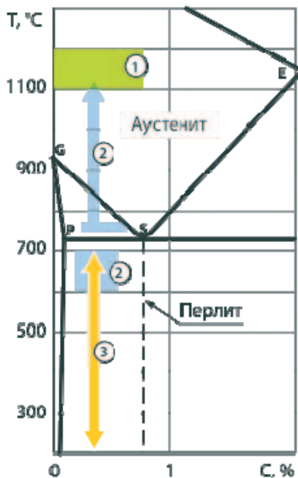
Рис. 1. Отжиг I рода (температурные интервалы нагрева)
