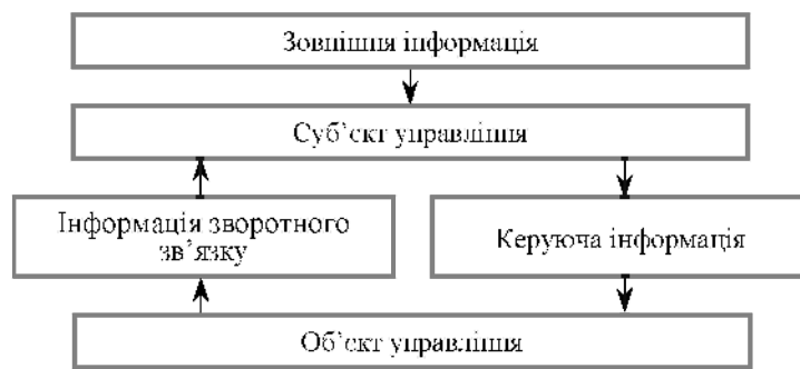
Рис. 2.5. Схема кібернетичного контуру управління зі зворотним зв'язком
