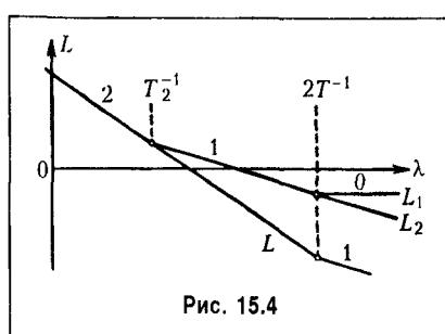
Для исключения этого явления примем желаемую л. а. х.  $L_2$  в другом виде (рис. 15.4). Желаемая передаточная функция
