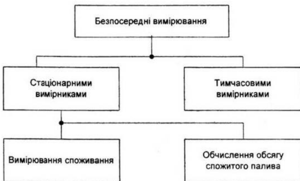
Рис. 2.2 Класифікація методів безпосереднього (прямого) вимірювання.
