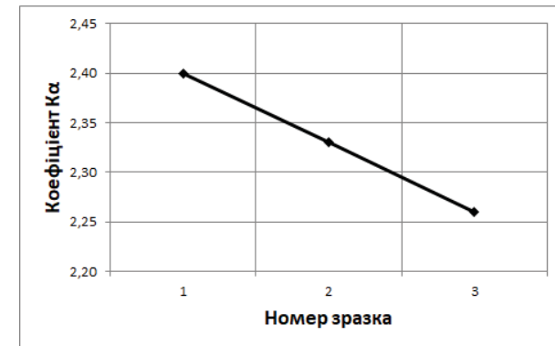
Рисунок 1.4 – Залежність коефіцієнта K_a від умов прокатки
