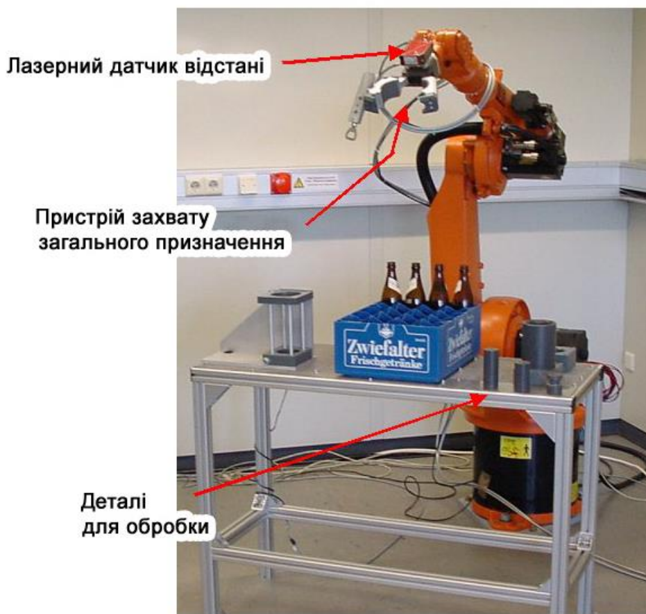
Рис. 14.2. ПР типу KUKA KR 6—2 і його складові частини
