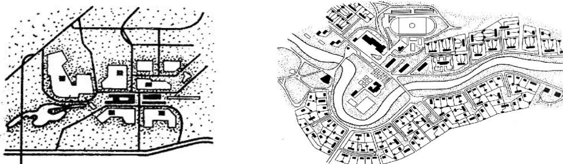
Рисунок 6.1 – Приклади планувальної моделі розміщення громадських центрів і установ обслуговування в малих містах
