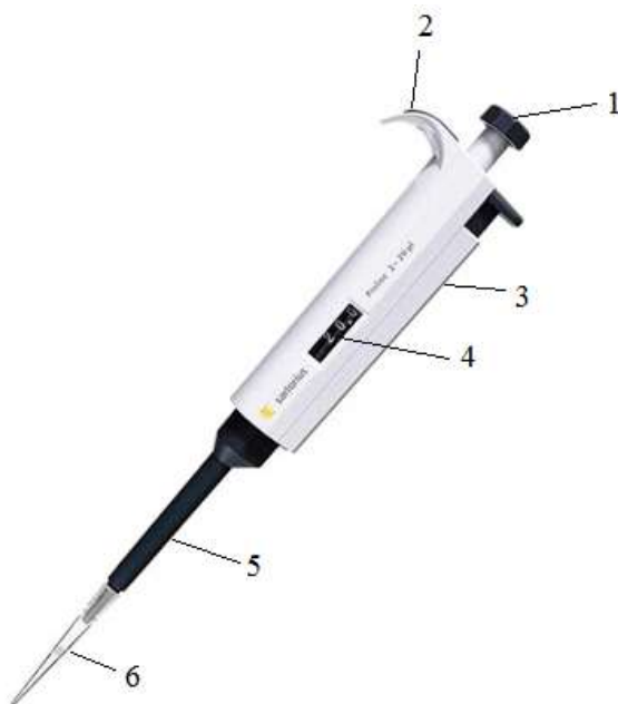
Рисунок 1 – Механічна одноканальна піпетка зі змінним об'ємом (BIONIT Proline): 1 – операційна кнопка; 2 – упор; 3 – рукоятка; 4 – цифровий дисплей; 5 – видаляч наконечників; 6 – змінний наконечник
