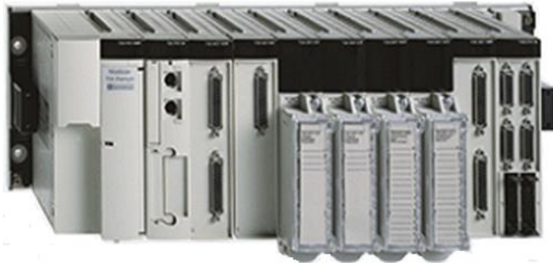
Рисунок 1 – Мікропроцесорний контролер Modicon TSX Premium
