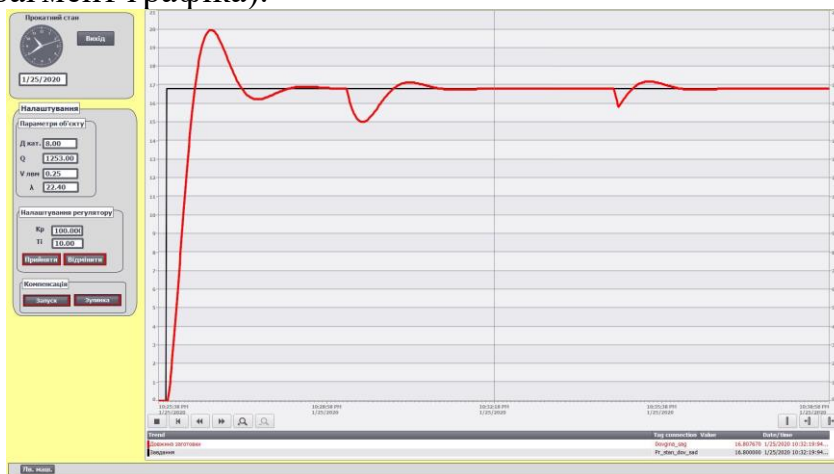
Рисунок 11.18 – Перехідні процеси в САР довжини заготовки
