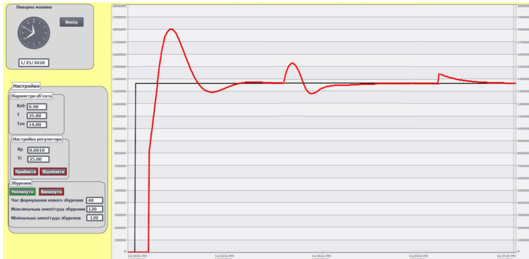
Рисунок 11.17 – Перехідні процеси в САР теплоти, що виноситься заготовкою з ливарного колеса
