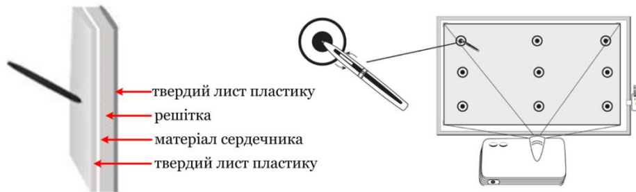
Рисунок 21 – Принцип роботи дошки за електромагнітною технологією
