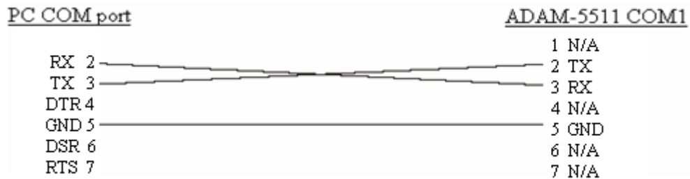
Рисунок 5.3 – Підключення ПК до «COM1» контролера
