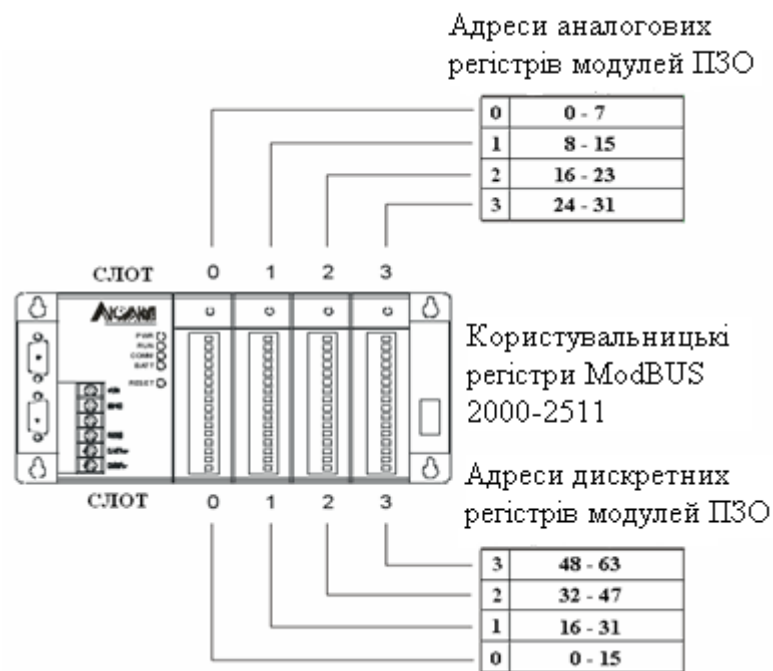
Рисунок 5.5 – Адресація регістрів модулів ПЗО серії «ADAM 5000»
