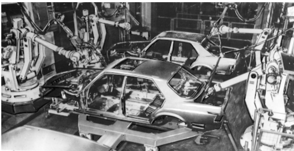
Рис.9.8. Участок точечной сварки роботами кузовов автомобилей.
