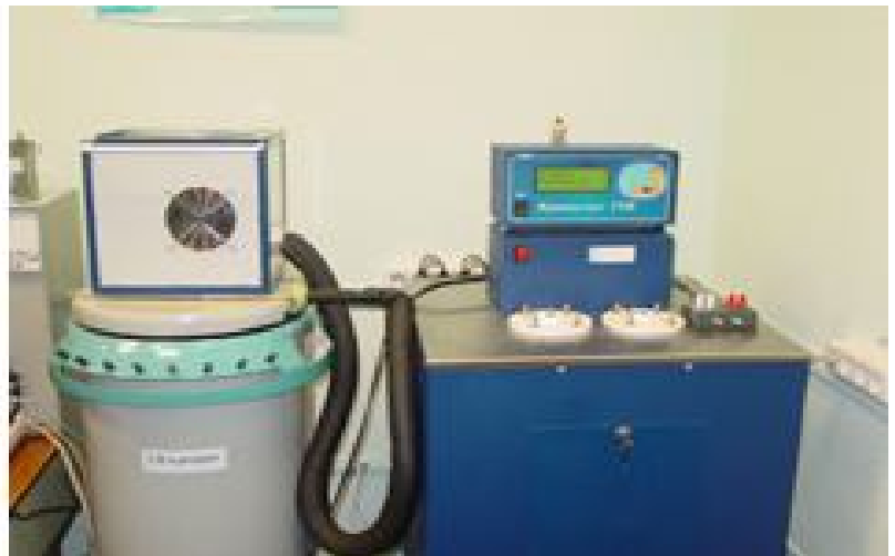
Рис. 1.8 - Еталон одиниці термодинамічної температури — кельвин
