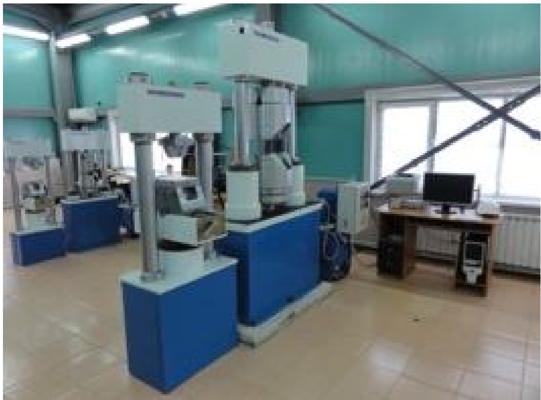
Рис. 3.8 - Зразки металу піддаються випробуванню розривними гідравлічними машинами
