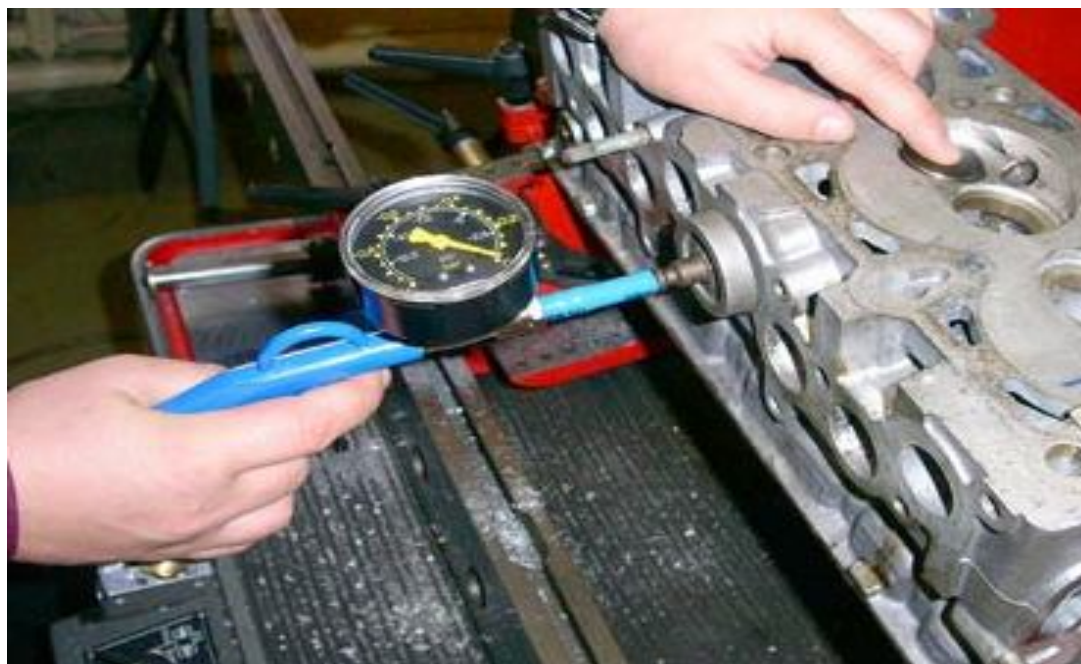
Рис. 3.12 - Застосування вакууму при контролі герметичності з'єднань
