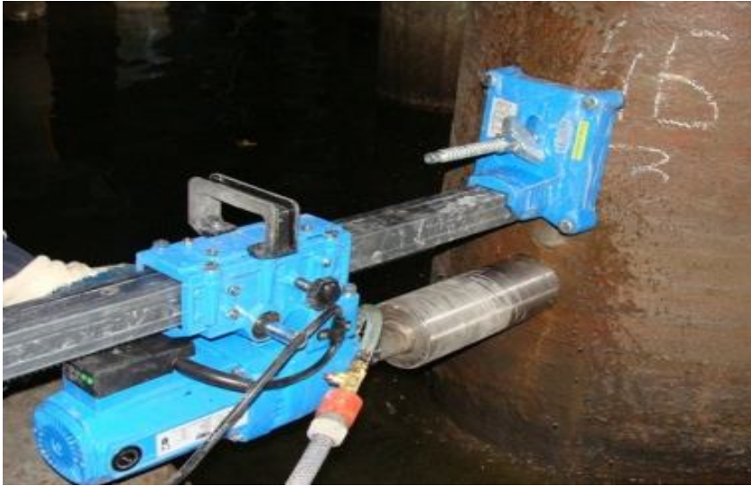
Рис. 3.9 - Зразки, вибурені з існуючих конструкцій системами алмазного буріння
