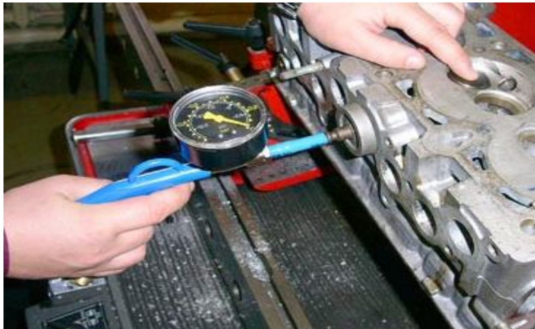
Рис. 3.12 - Застосування вакууму при контролі герметичності з'єднань
