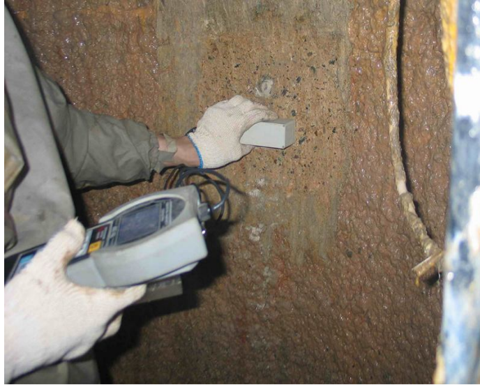
Рис. 3.29 - Визначення захисного шару бетону приладом ІЗС-10Ц
