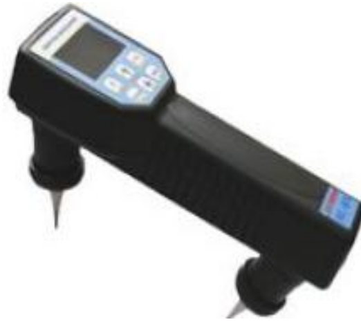
Рис. 3.26 - Дефектоскоп ультразвукової для визначення міцності бетону
