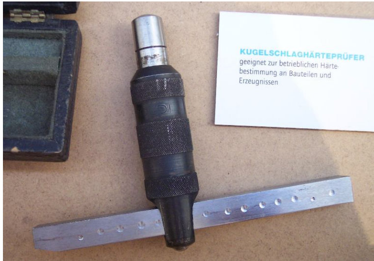
Рис. 3.14 – Схема приладу Польді: 1 – куля; 2 – сталевий брусок; 3 – сталевий брусок; 4 – ударний молоток
