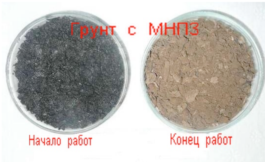
Рис 9.2 Той же грунт після переробки - 7 жовтня 2008 р.
