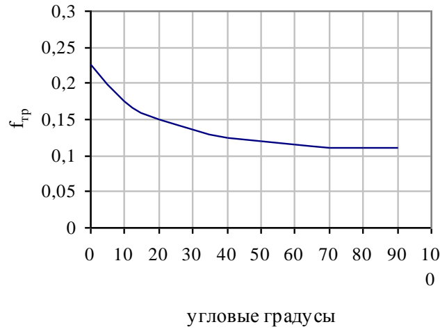
Рисунок 4.10 – Залежність коефіцієнтів тертя ВВКМ на основі ВКН – 5000 (армований \pm 30^\circ ) від розташування поверхні тертя до напрямку армування
