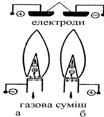
Рисунок 5.3 - Вплив електричного поля на позитивно та негативно заряджений пальник.
