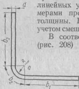
Рис. 208. Схема для определения ширины исходной заготовки для профилирования угольника.
