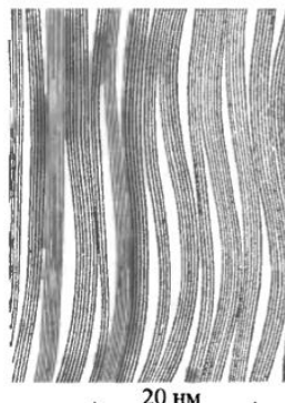
Рисунок 3.2 - Схемне зображення стрічкової структури вуглецевого волокна
