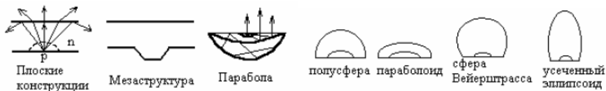
Рисунок 2.2 - Конструкции излучающих диодов [9]
