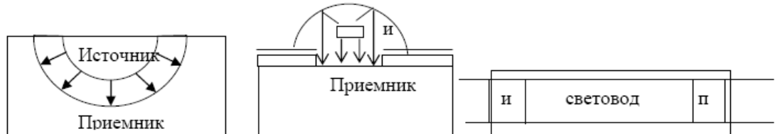
Рисунок 5.3 -. Конструкції оптопар с более эффективной передачи излучения[13]
