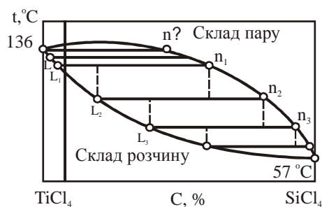
Рисунок 5.6 - Діаграма залежності складу С пару від складу розчину для системи TiCl_4-SiCl_4
