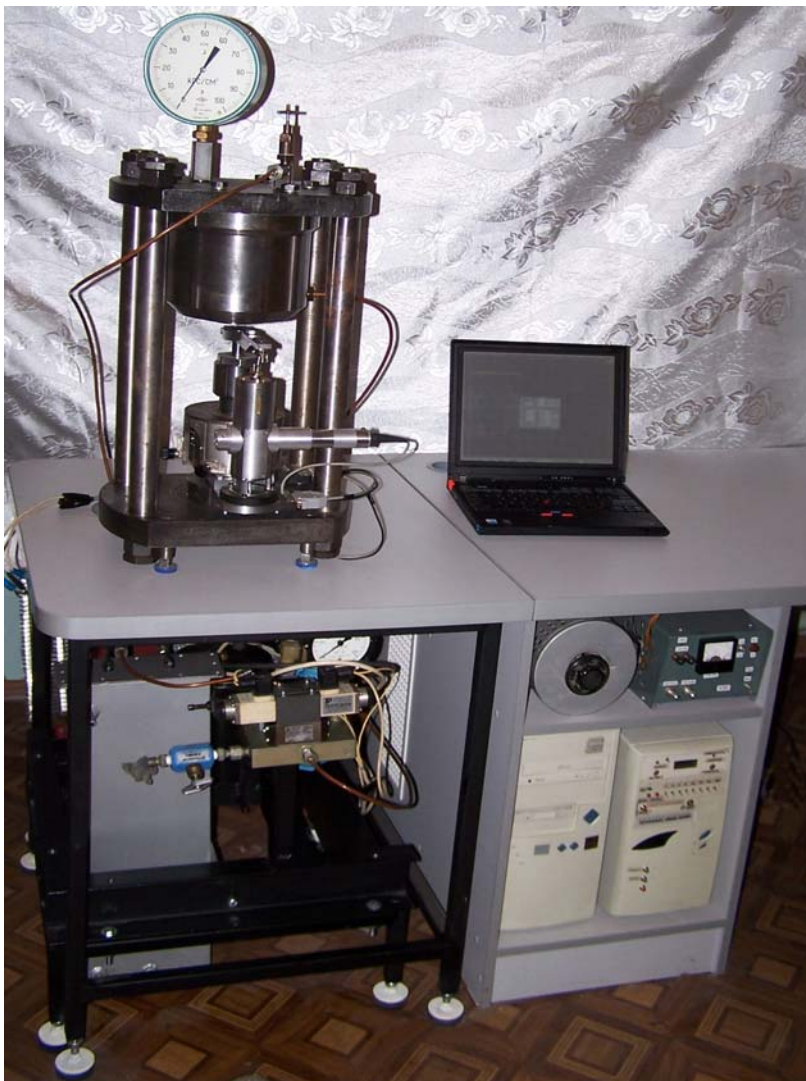
Рисунок 3.48 – Загальний вид дослідницького комплексу для вивчення компресійних характеристик продуктів харчування
