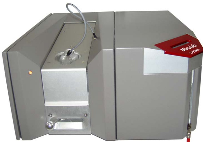
Рисунок 3.46 – Загальний вигляд приладу для визначення реологічних властивостей тіста Mixolab
