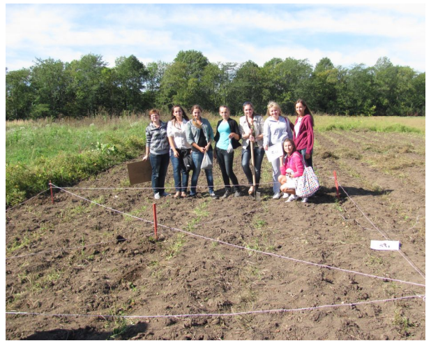
Рис. 8.10. Відбір проб ґрунтів здійснюється методом «конверта» згідно державного стандарту
