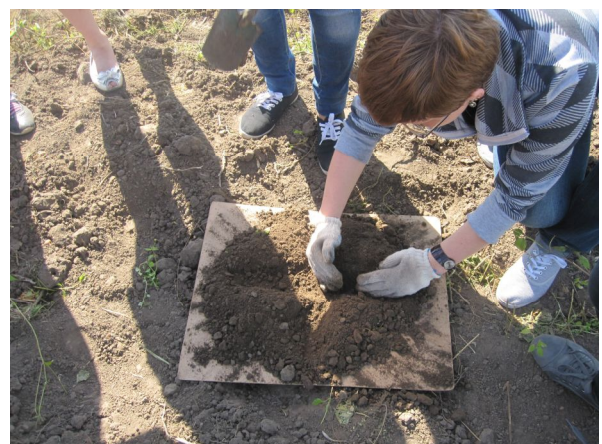
Рис. 8.14. Відібрані у чотирьох кутах і у центрі «конверта» проби переміщуються, квартуються і таким шляхом формується одна проба
