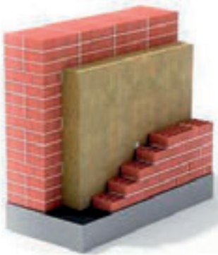
Рис. 2.4.4. Утеплення фасаду в середині стіни
