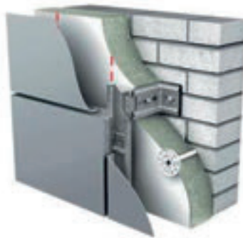
Рис. 2.4.5. Вентильована система фасаду з утепленням ззовні
